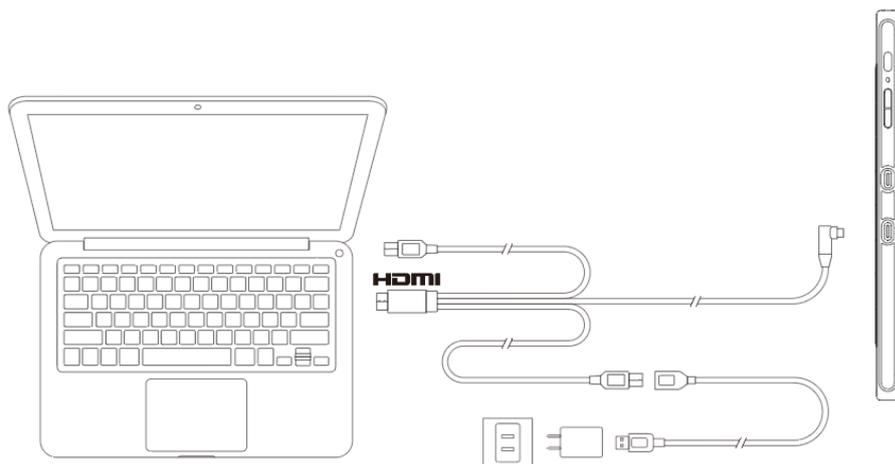
Обычно питание подается на устройство при подключении черного кабеля USB-A к компьютеру. Мигающий экран устройства может указывать на низкий уровень питания. В этом случае рекомендуется подключить красный кабель USB-A ко второму порту USB на компьютере или к адаптеру питания.
